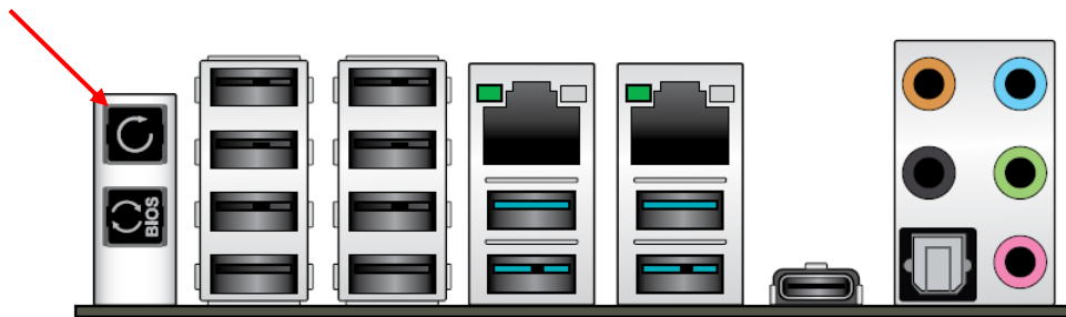
Figure 4.16 Emplacement du bouton de réinitialisation du CMOS
