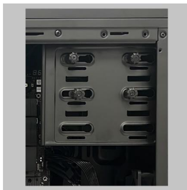
Baies de disques
